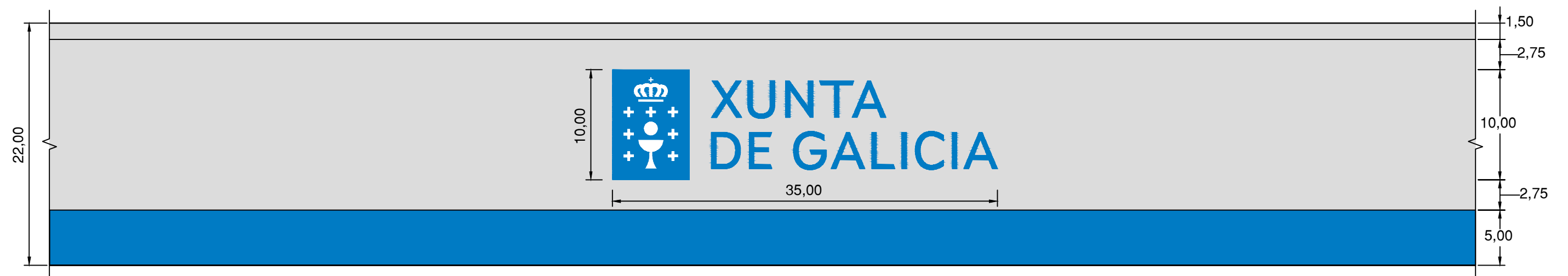
DETALLE DE BORDO CO LOGOTIPO DE XUNTA DE GALICIA (COTAS EN CENTÍMETROS)
